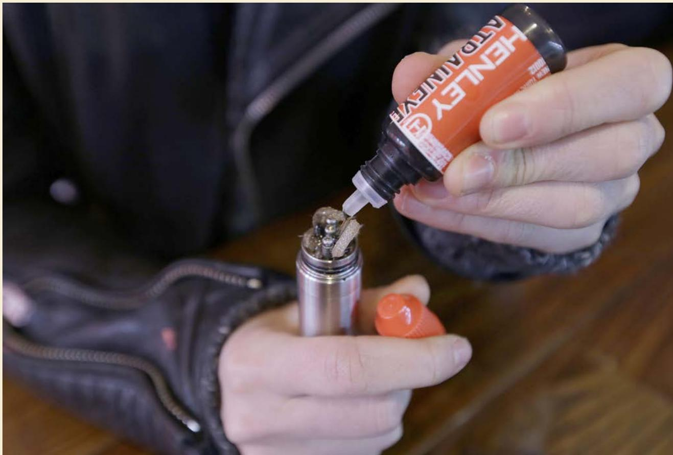
虽然制造商提供很多款不同的电子烟，但每一款的基本概念都相同：一端的加热原件使液态尼古丁溶液雾化，通过烟嘴吸入蒸气。© AP Photo/Frank Franklin II
